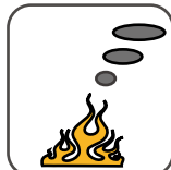
Low Smoke Emission IEC 61034-1&2 EN 50268-1&2/NF C32-073
